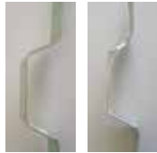
板金職人 従来品 切断材: 角スパン (ガルバリウム鋼板)
